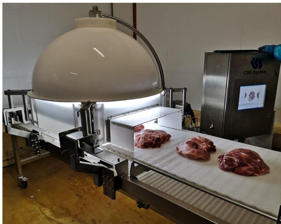
Figure 11 : système automatique de tri visionique des jambons déstructurés « CSB-Jamboflash » (CSB System et IFIP)
