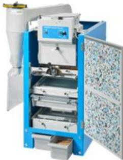
Trieur optique visible et infrarouge
