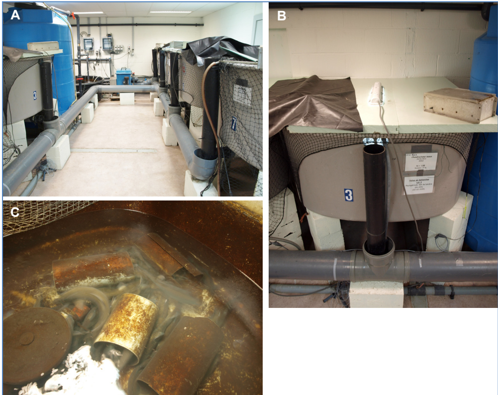
Figure 3. Circuit recirculé pour le maintien des géniteurs (A); bassin de stabulation avec système d'éclairage contrôlé et nourrisseur automatique (B); abris en PVC posés sur le fond d'un bassin de stabulation de géniteurs (C).
